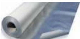
Oddělovací AL fólie pro podlahové vytápění vícevrstvá (polyetylenová fólie, PE zpevňující mřížka a Al vrstva). Pokládá se na tepelnou izolaci Al vrstvou.
