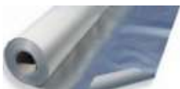
Oddělovací AL fólie pro podlahové vytápění vícevrstvá (polyetylénová fólie, PE zpevňující mřížka a Al vrstva). Pokládá se na tepelnou izolaci Al vrstvou.
