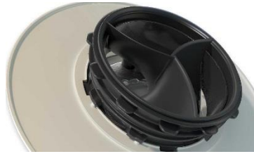
Náběžová vložka optimalizuje proudění vzduchu, snižuje odpor ventilu a tím i hlučnost
